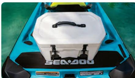
**Платформа для купания с встроенной системой крепления LinQ**
